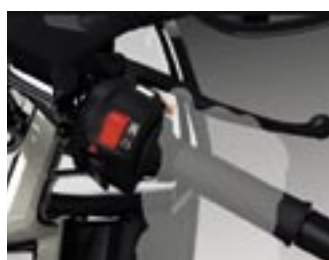
Von den Lenkerarmaturen links und rechts werden die „Gangschaltung“ sowie die verschiedenen Fahrmodi bedient
